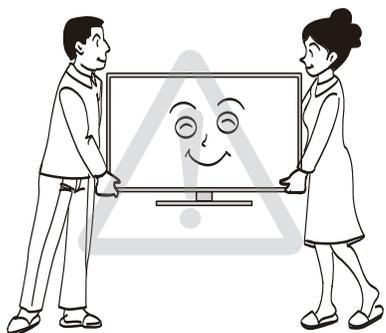
移动电视机时，请确认插头从电源插座上拔下并断开天线、音频/视频连接线及任何固定线的连接。搬动电视机时，至少需要两个人，务必直立搬动。勿平放电视机。
