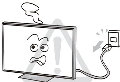
电视机发生故障、冒烟或发出异味时，请立即关闭电视机，并从插座上拔下电源插头。确认烟雾和异味已消失后，请联系维修服务部。
