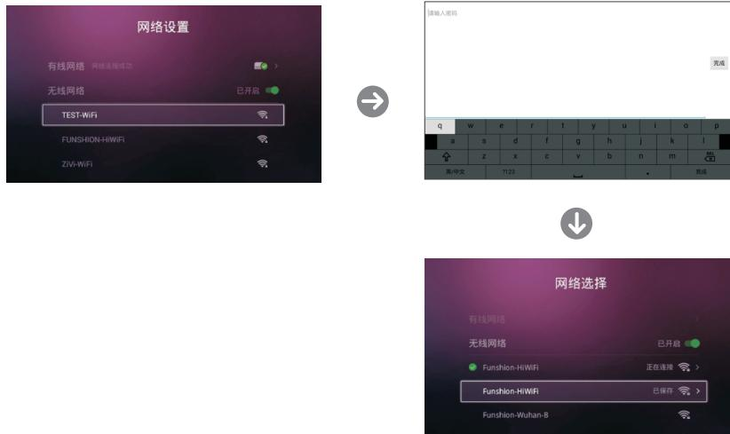
备注：网络连接以无线为优先，当您无线连接到网络时，会自动断开您的有线连接。
