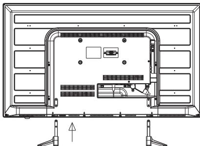
2. 将电视机背面底部的四个孔打上4颗(4x26PWM)螺钉并拧紧,安装完成。
