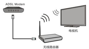
注: • 该图片仅为无线网络某一连接方式示意图,具体连接方式请以用户实际网络配置的连接为准。 本机提供三种连接方式给用户选择,用户选择连接成功后,系统会自动记忆用户选择的连接方式,以后 每次使用网络都可自动连接,不需要反复设置(ADSL拨号上网除外)。选择"系统设置—>网络设置",按 OK键讲入菜单详情。
