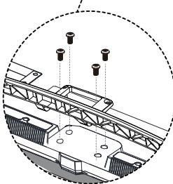
注：固定底座螺钉或相应塑胶件禁止接触油脂及有机溶剂。
