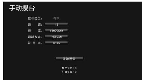
调制方式：16QAM、32QAM、64QAM、128QAM、256QAM，按上/下键选择调制方式，按OK键确认。
