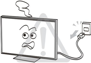
电视机发生故障、冒烟或发出异味时，请立即关闭电视机，并从插座上拔下电源插头。确认烟雾和异味已消失后，请联系维修技术人员。联系电话：4008-123456
