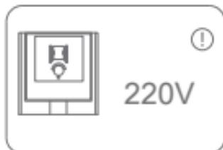
电源输入及与电器设备连接所用的铜导线应与负载功率相匹配。
