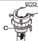
5. 以顺时针方向将进水管的另一端拧紧在洗衣机进水口上。
