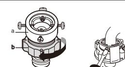
4. 按住滑动器c，将进水管与接头连接，松开c部分使其自动结合；发出“咔嗒”声表明已自动结合。
