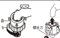
3. 连接器套上水龙头向上与水龙头靠紧后，用螺丝锁紧，再转螺母b部分使ab合并。
