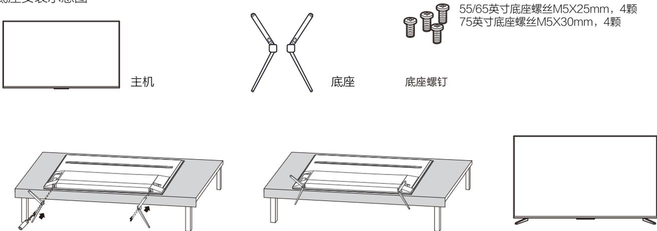
注：固定底座螺钉或相应塑胶件禁止接触油脂及有机溶剂；后壳的外观以实物为准，装配方式相同。
