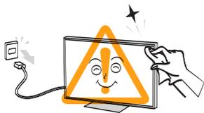
清洁前请拔掉电源插头。请勿使用汽油或稀释剂等溶剂来清洁电视机。这些溶剂可能会使外壳变形或漆面受损。
