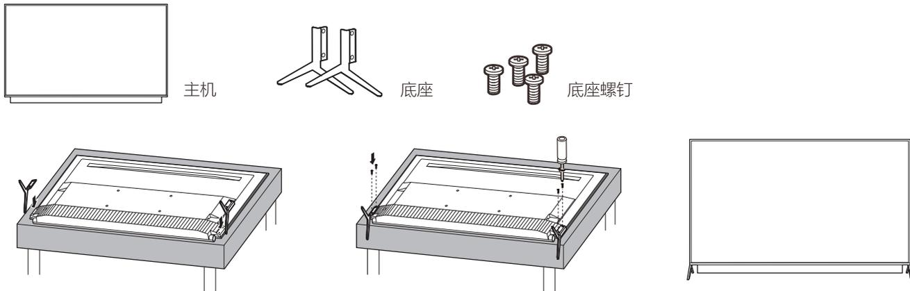
注：固定底座螺钉或相应塑胶件禁止接触油脂及有机溶剂。
