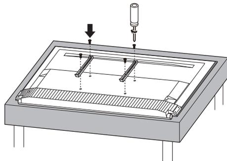
② 用后壳取下的四颗VESA螺钉固定上面的四个挂架孔，把挂架锁到电视整机上
