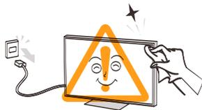
清洁前请拔掉电源插头。请勿使用汽油或稀释剂等溶剂来清洁电视机。这些溶剂可能会使外壳变形或漆面受损。如果橡胶或乙烯基制品与电视机长期接触，可能会留下污渍。如果外壳变脏，请用柔软干布擦拭。清洁液晶显示屏的表面时，请用柔软的干布轻轻擦拭液晶屏幕表面。
