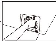
装上排水泵的泵盖并拧紧，将旋钮保持垂直，如图。将紧急排水管固定回原处，装上排水泵保护盖！
