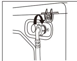
重新连接进水管。打开水龙头，检查确保不漏水。
