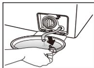
将紧急排水管从固定处取出，拔下紧急排水管塞子，将残留的水排出，排水结束后装回塞子；
