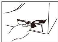
用薄片如硬币等按图示方向拆下排水泵保护盖；
