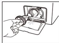
慢慢拧下排水泵的泵盖，取出排水泵内的衣物残渣，并彻底清洁，直至叶片可以自由转动；
