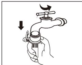
关闭水龙头，从水龙头上拆下进水管，并用小刷子刷洗过滤网；
