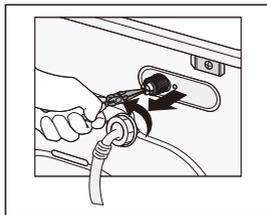
从机器的背面拧下进水管，用尖嘴钳拔出过滤网，清洗后装回；
